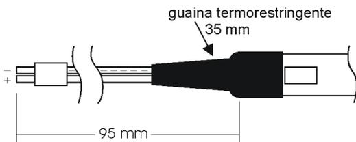
numero di STRIP5 collegabili in serie: 15 metri / maximum series connected modules: 15 meters
