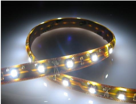
Striscie flessibili, frazionabili ogni 5 cm, 60 LED per metro, con cavi di collegamento 0,22 mmq lunghezza 10 cm, impermeabilizzata con strato di silicone, grado di protezione IP67, autoadesiva.
