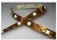
Striscia Flessibile, frazionabile ogni 10 cm, con adesivo, 150 LED RGB FC per metro, con cavi di collegamento 0,22 mmq lunghezza 25 cm / Flexible Strip, cuttable every 10cm, with adhesive tape, 150 LED RGB FC for each meter, with 0,22 mmq wiring cables 25 cm long
