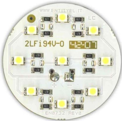
Modulo con 9 LED PLCC2, diametro 4 cm, connettore 2 vie sul retro
